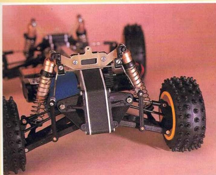
Carrossage réglable et barre anti-roulis avant et arrière sur modèle compétition.
